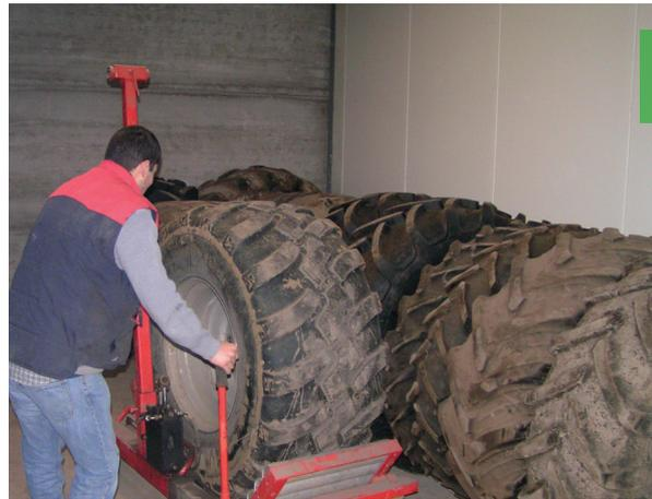
Il est recommandé de regrouper toutes les roues dans un local proche de l'atelier, facilement accessible et suffisamment spacieux pour permettre le déplacement avec un chariot à roues. Veillez à stocker les roues à l'horizontale ou à la verticale, mais jamais en position inclinée contre un mur. Dans tous les cas, prévoyez des cales en bois afin d'assurer leur stabilité.
