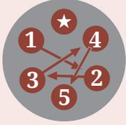
Il est indispensable d'enclencher le frein de parking et de caler le tracteur. Le déboulonnage doit se faire en croisant et en alternant les écrous. Laisser un dernier écrou légèrement serré pour maintenir la roue en place.
